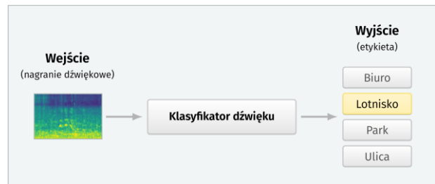
Rys. 1. Schemat działania klasyfikatora dźwiękowego, przypisującego pojedynczą etykietę do nagrania.
